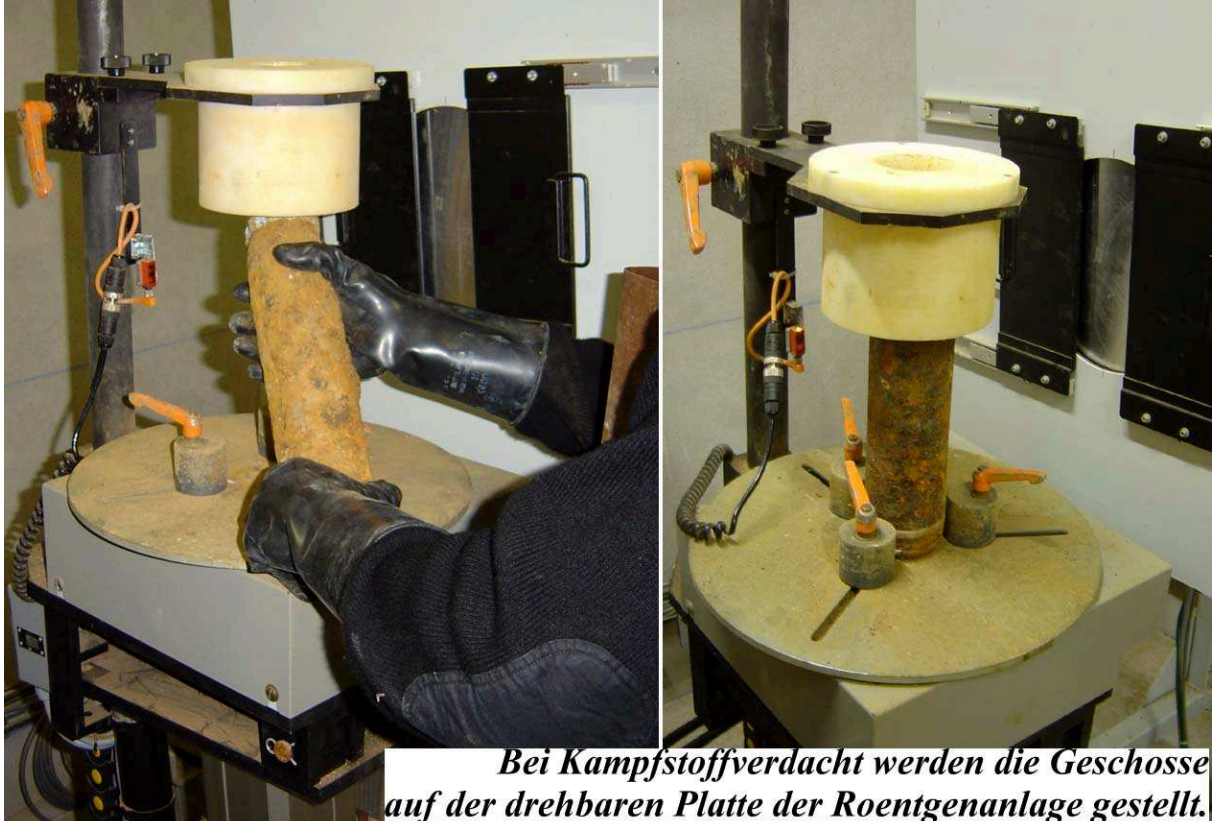
Les obus suspectés de chargement toxique sont placés sur le plateau rotatif de l'installation de radioscopie.
